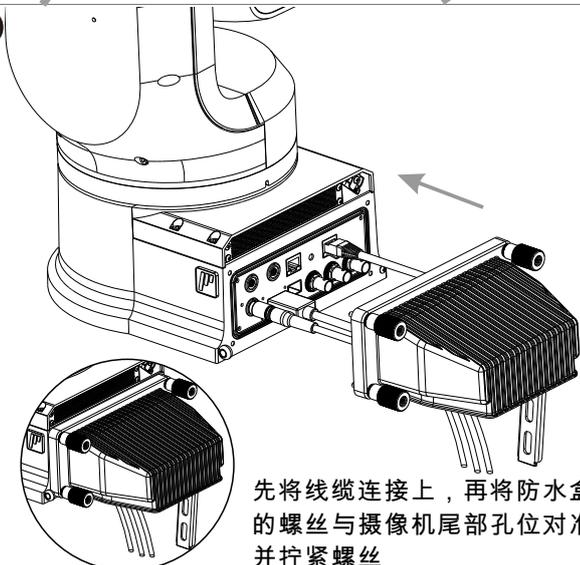
先将线缆连接上, 再将防水盒的螺丝与摄像机尾部孔位对准并拧紧螺丝
