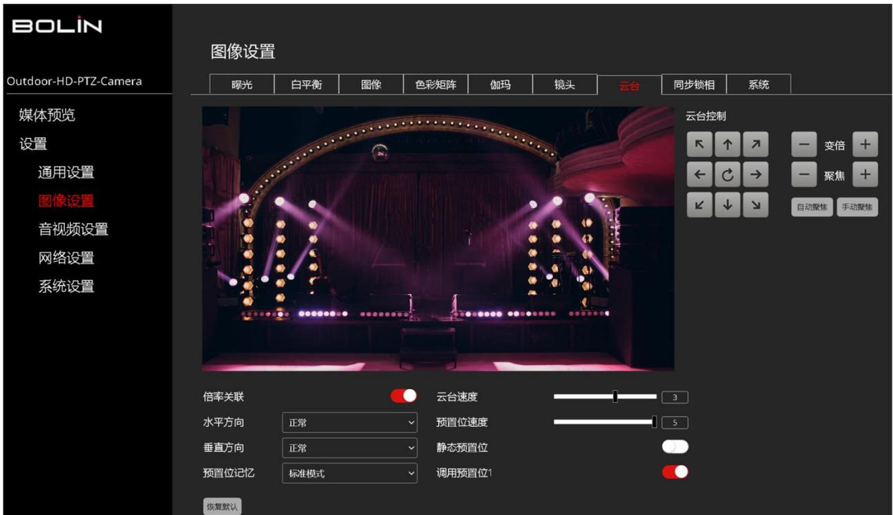
**倍率关联:** 设为“开”时，云台速度与变倍倍数匹配。发生变倍时，随之匹配最佳的云台转动速度。设为“关”时，速度匹配关闭，倍速变化与云台速度无关。云台速度始终为1倍时速度。
