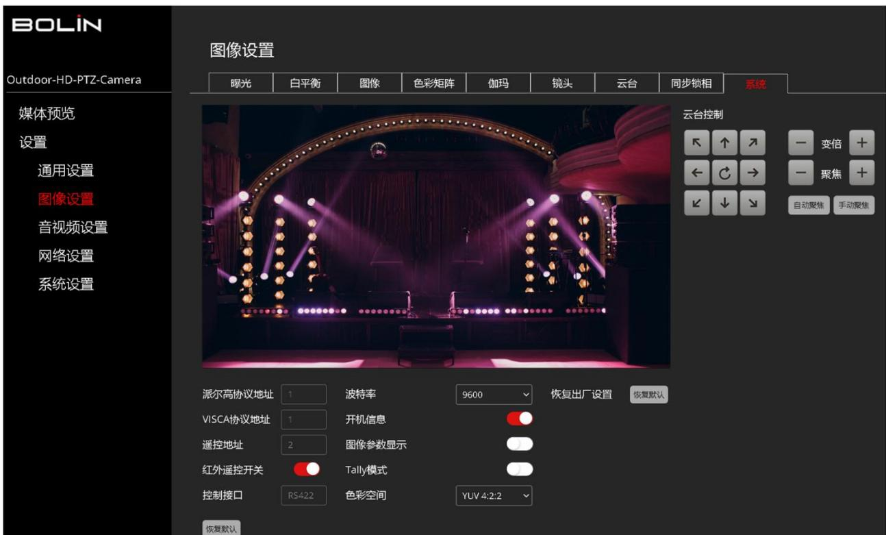
**派尔高协议地址:** 使用 RS-485(PELCO P/D)控制摄像机, 需要设置派尔高地址。设置值范围: 1-255。
