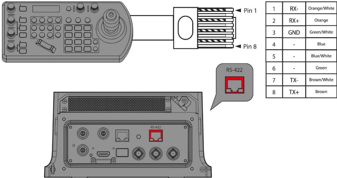
或者，您可以使用 CAT5/6 T-568B 标准网线直接连接摄像机和控制器来建立 RS485 连接。
