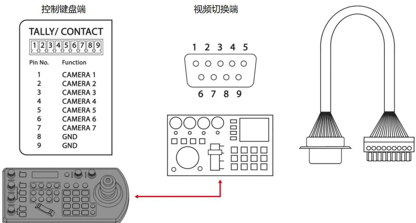
3. 键盘控制器侧我们使用引脚 1 到 8 引脚，视频切换器侧我们使用引脚 1 到 9 引脚（引脚 8 除外）。
