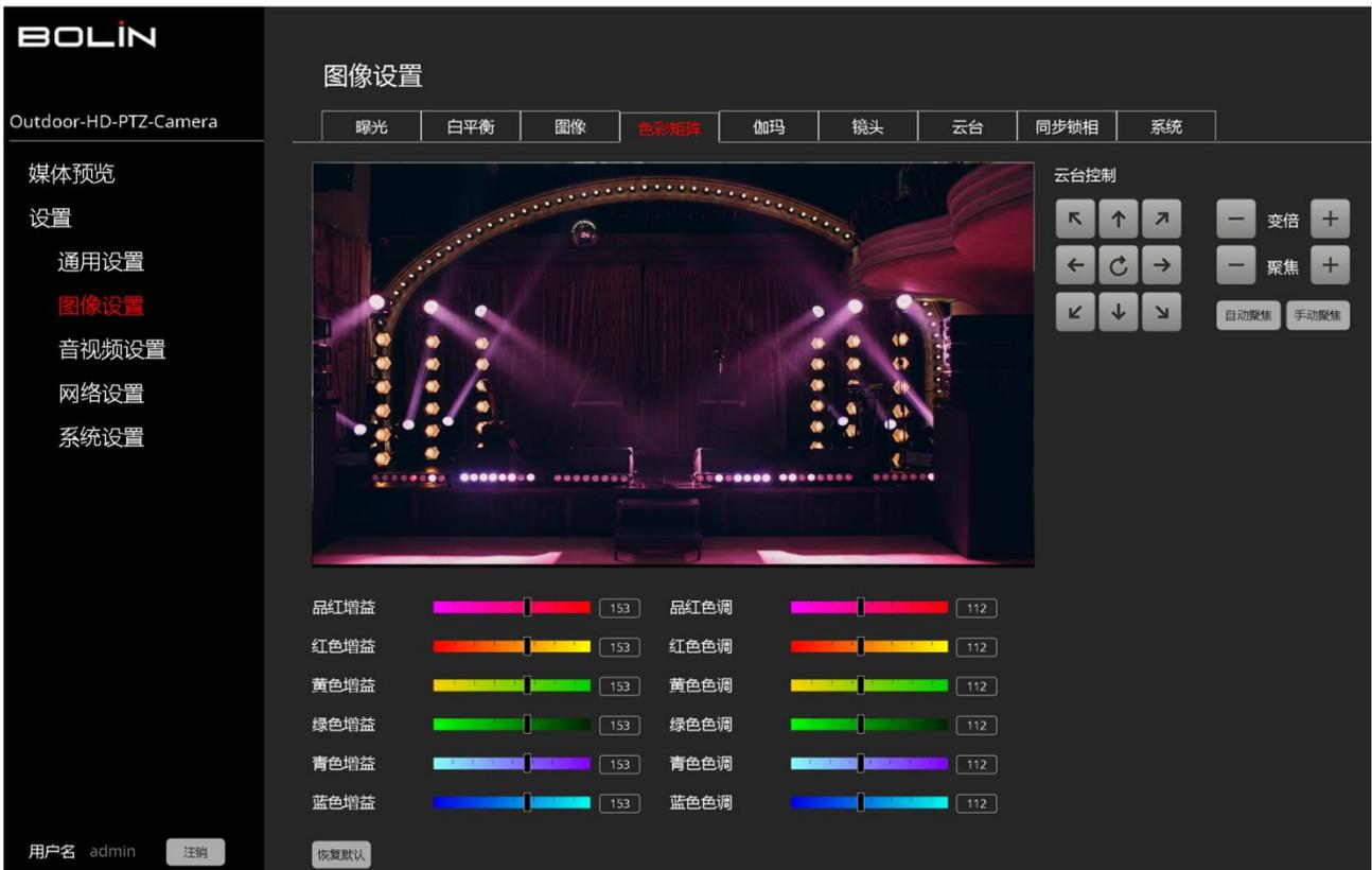
每个颜色的增益定义了该颜色在图像中的表现强度。默认级别（128），其显示包含颜色的所有像素之间的均匀偏差。红色与品红一样生动地显示红色成分，这通常会给您的颜色表现带来平衡的效果。增加增益值将为此颜色相关的图像的所有部分增加额外的强度。
