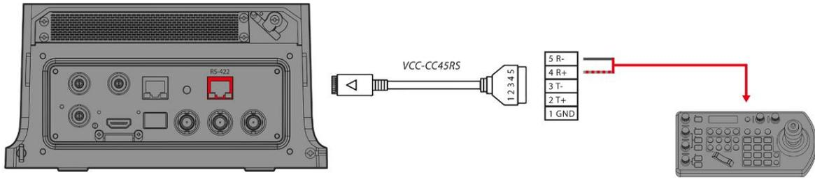
使用所提供的延长线以及 RJ45 转 RS422 凤凰端子连接器适配器来为控制设备建立 RS422 连接。
