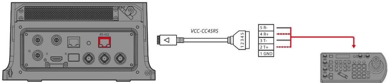
使用 RS422 标准串口控制器与多个摄像机进行 RS422 菊花链连接。
