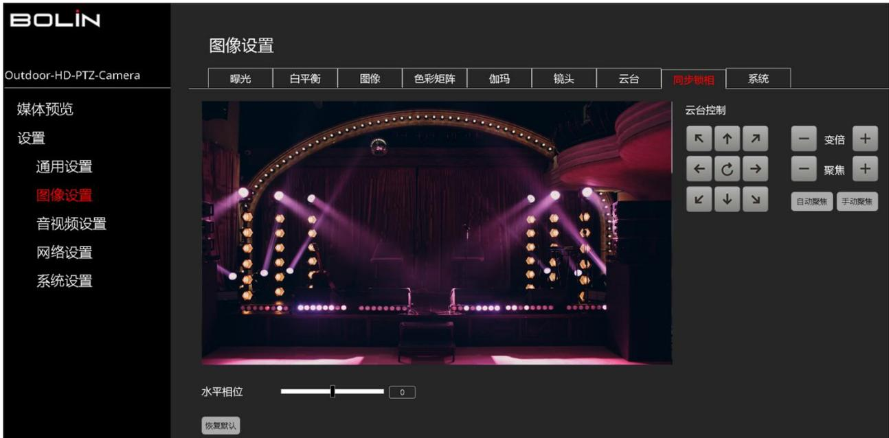
**水平相位：**此功能可以让您调节外部同步信号与摄像机的图像信号之间的相位差。调节范围为 -127 到 0 到 +127。当视频信号和外部视频同步信号不同步时，水平相位的 1 档时间为 0.0135  $\mu$ s。
