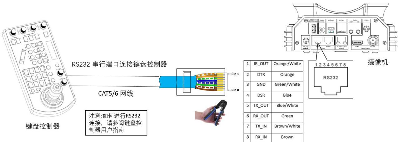
11. 使用 RS-232 菊花链多摄像机与标准 RS-232 串口键盘控制器连接:
