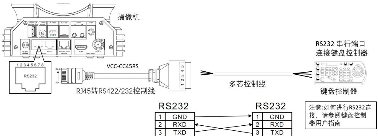
10. 使用 CAT 5/6 网络电缆 (T-568B 标准) 通过以下引脚定义与键盘控制器进行 RS-232 连接:
