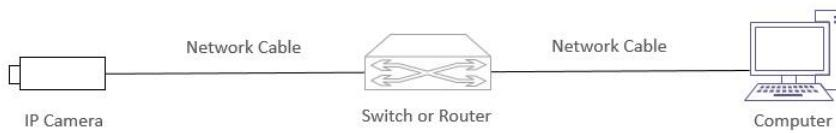
使用屏蔽双绞线（STP）电缆连接摄像机和交换机或路由器的网络接口。
