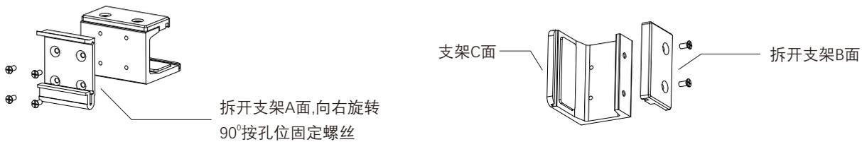
拆开支架A面,向右旋转90°按孔位固定螺丝
