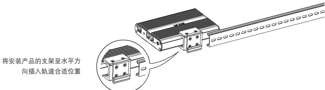
将安装产品的支架呈水平方向插入轨道合适位置
