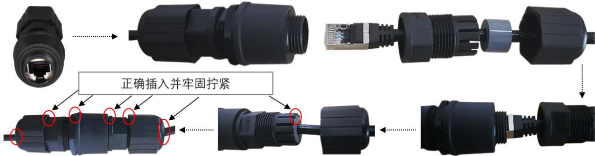
RJ45连接器+防水连接器安装
